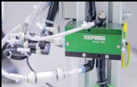
DEPRAG deeltjesfilter Vuildeeltjes worden opgespoord en afgevoerd uit het toevoersysteem
